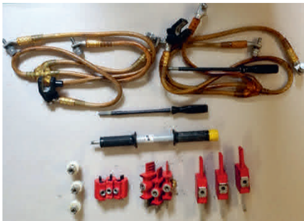
Esempio di utensili di messa a terra e corto circuito in reti in cavo a bassa tensione
